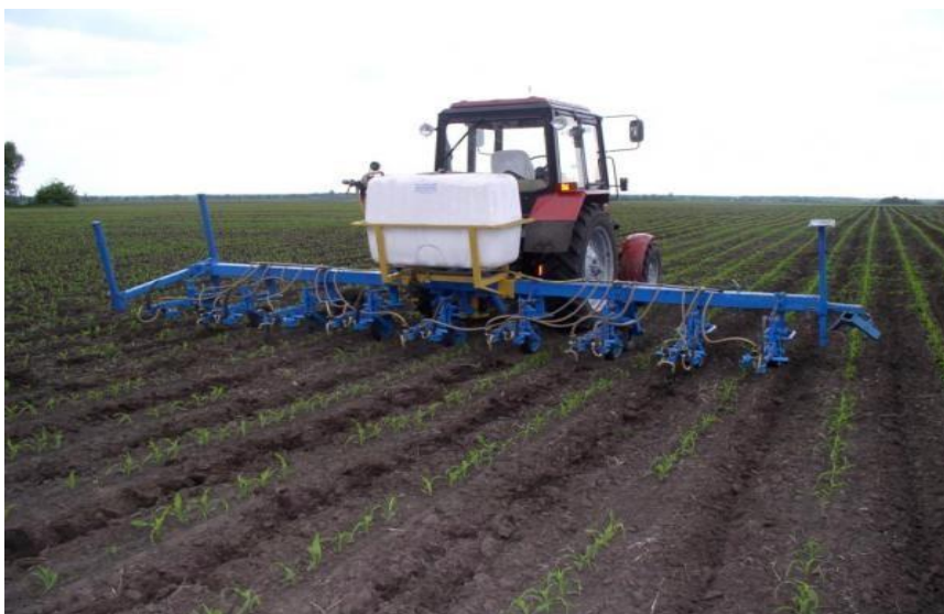
Рис. 2. Культиватор обладнаний обприскувачем
