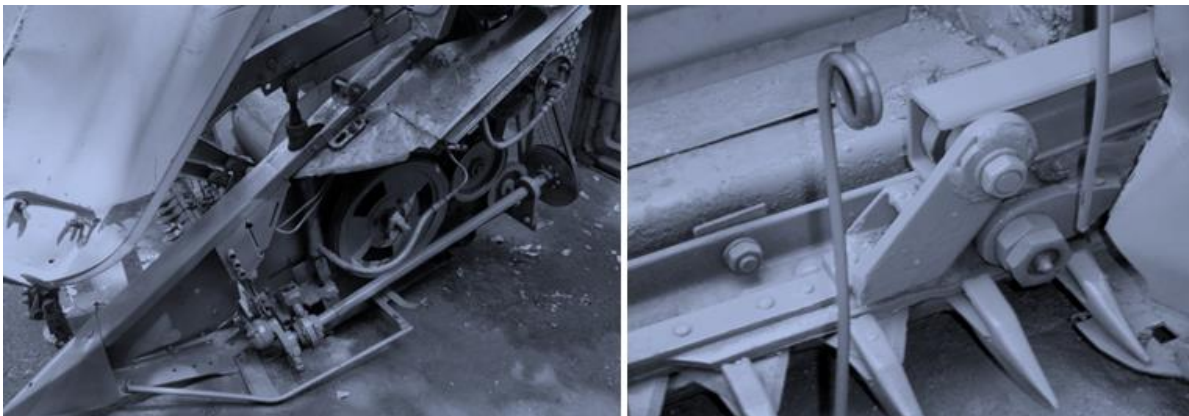
Рис. 1. Різальний апарат жнивarki комбайна з виглядом на кулькову підвіску п'ятки ножа
