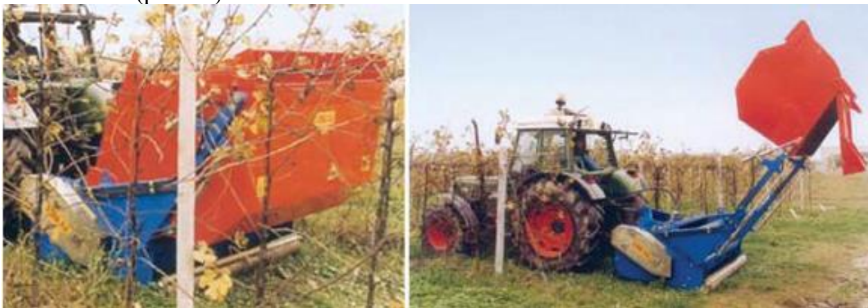
Рис. 2. Машини для збирання і подрібнення зрізаних гілок в міжряддях садів і виноградників фірми «I.ME.SA» (Італія)
