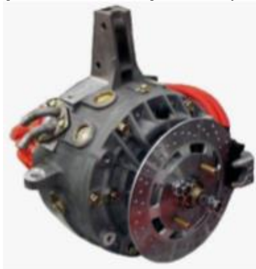
Рис. 2. Загальний вигляд тягового електродвигуна з вбудованим редуктором і дисковими гальмами
