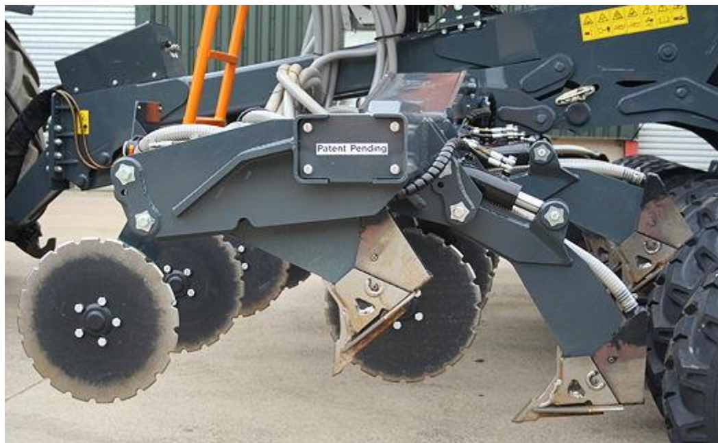
Рис. 2. Робочі органи сівалки сівалці MZURI
